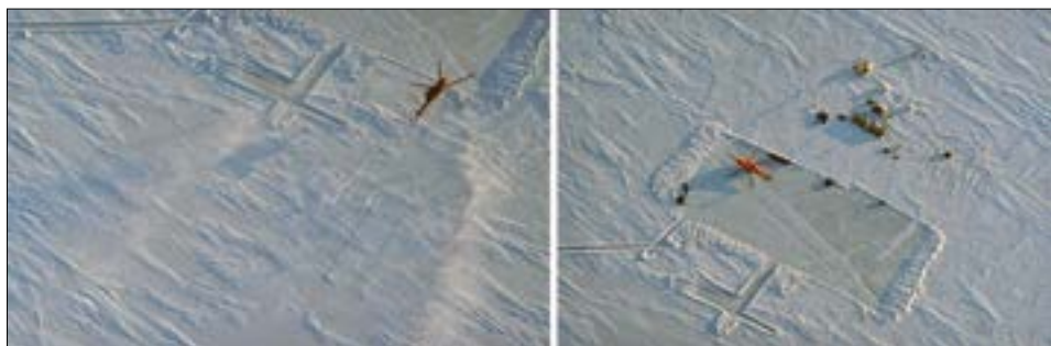
РИС. 3. АЭРОДРОМ И ЭКСПЕДИЦИОННЫЙ ЛАГЕРЬ РЯДОМ, ГРАНИЦЫ ВПП И ОДНОРОДНОСТЬ ВЫБРАННОЙ ДЛЯ АЭРОДРОМА ЛЬДИНЫ (ПО МАТЕРИАЛАМ ГК «БЕСПИЛОТНЫЕ СИСТЕМЫ»)
