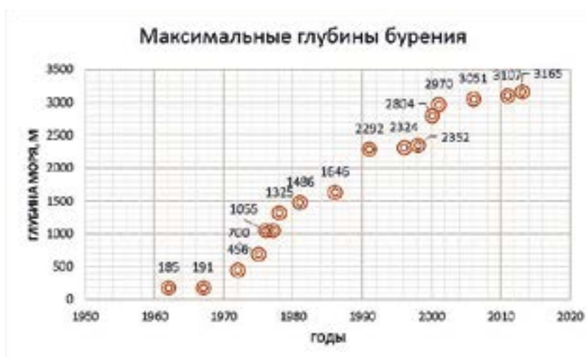
Рисунок 1. Максимальные глубины моря, на которых осуществляется бурение скважин [1].
