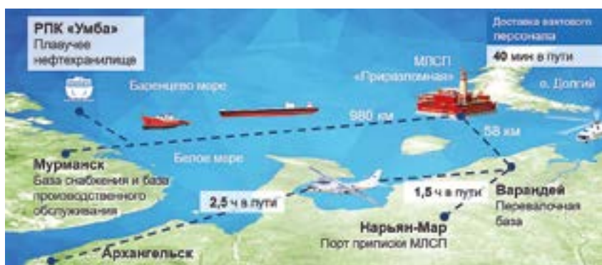
Рисунок 5. Транспортно-логистическая схема в рамках проекта «Приразломное» [3].
