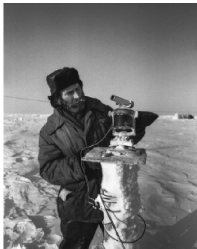
Метеоролог- актинометрист Владислав Селицкий осматривает прибор для измерения солнечной радиации. ▶
